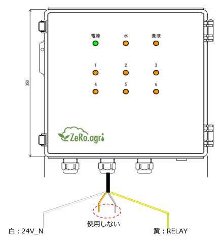
AC 24V (ノーマルクローズ) の電磁弁を信号線へ圧着し、接続してください。 ACの場合は極性はありませんので、どちらに接続しても構いません(DC電磁弁は使用できません)。
