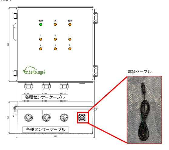
■制御盤本体 簡易接続図 ※オレンジ色の線はカスタム注文時のみ付属します、詳細はお問い合わせください。
