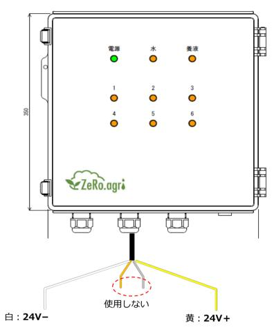
DC 24V(ノーマルクローズ)の電磁弁を信号線へ圧着し、接続してください。 DCの場合は、極性を確認して、接続してください(AC電磁弁は使用できません)。
